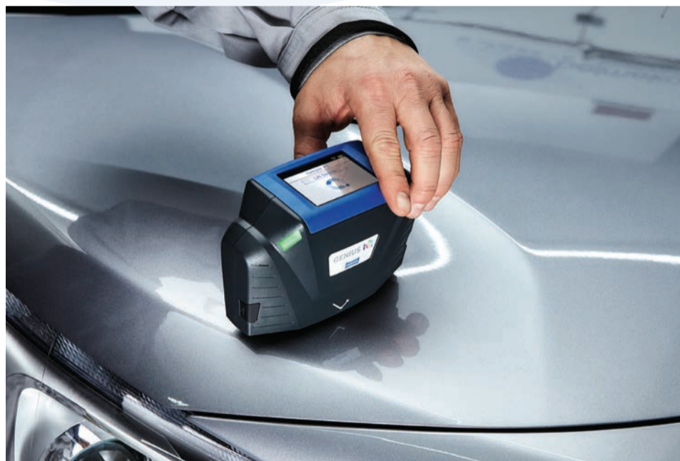
Měření barev se provádí přímo na karoserii spektrofotometrem Genius iQ s podporou Wi-Fi.
