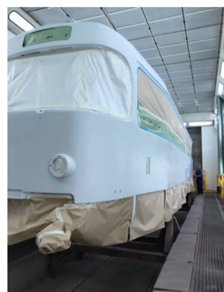
Vybrušená a zalepená tramvaj pro vrchní barvy.
