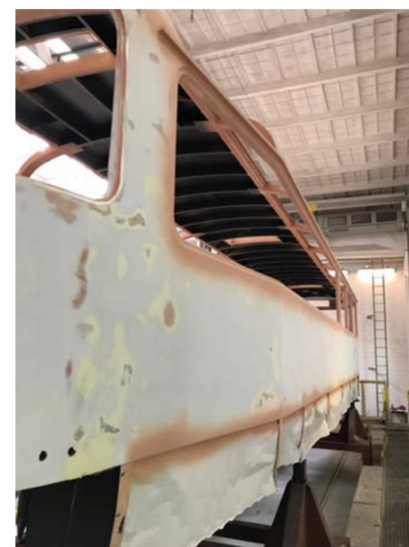
Tramvaj po tmelení a vybrušení. Na probrusy byl znovu použit EP zklád.
