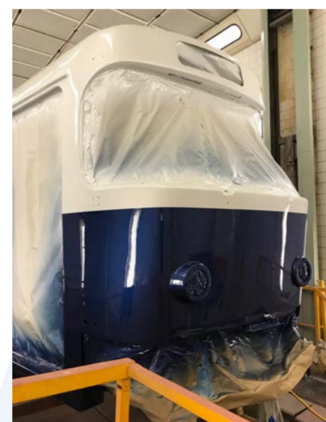
Po finálním bezbarvém laku Standofleet HS Plus Klarlack s tužením 5 : 3 v anti-graffity variantě.
