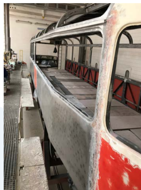
Hrubá stavba, při které byly použity původní díly z tramvaje T3 a nové díly podle návrhu Anny Marešové.
