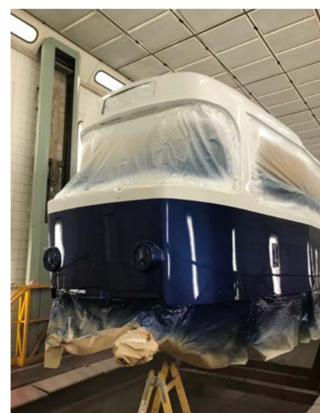
Po prvním bezbarvém laku Standofleet HS Plus Klarlack, tužením 3 : 1.
