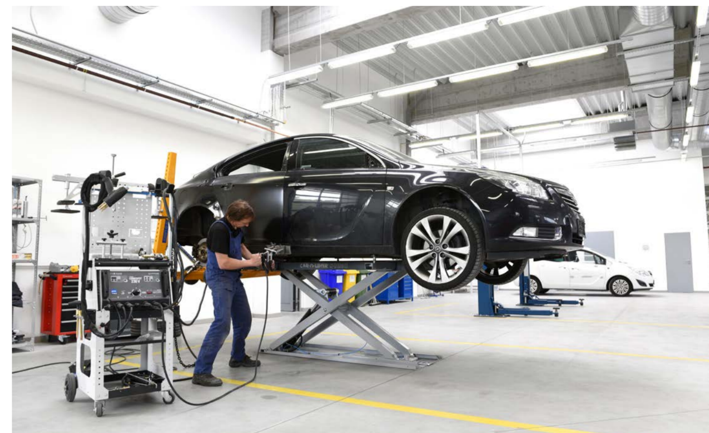
Karosárna byla osazena rovnací stolicí Speed, kterou lze využívat i jako karosářský zdvih.
