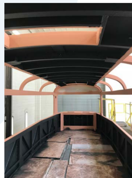
Nástřik vnitřních nepohledových částí o spodku vozu materiálem Mäder Aquaverm Grimmer Farbe.
