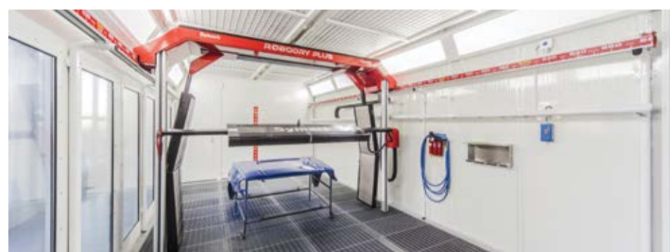
V jednom lakovacím boxu je nainstalován sušící robot Symach RoboDry.
