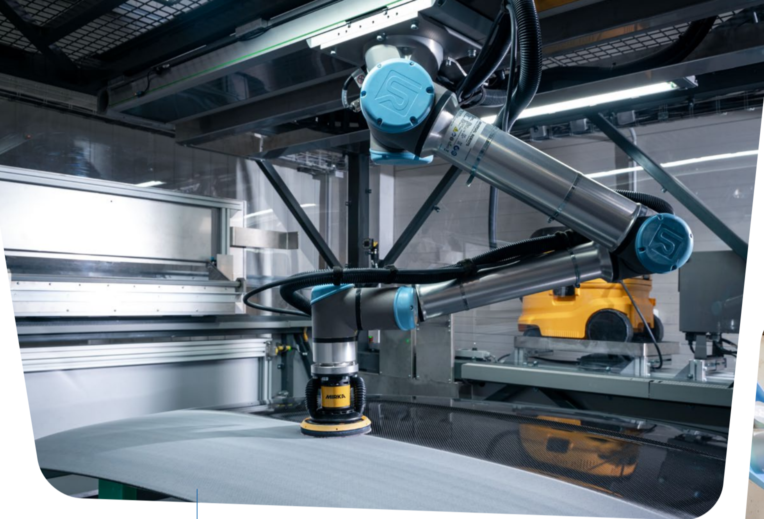
Šestiosé robotické rameno pro broušení karbonových střeš je rozšířeno o sedmou osu pojezdu
