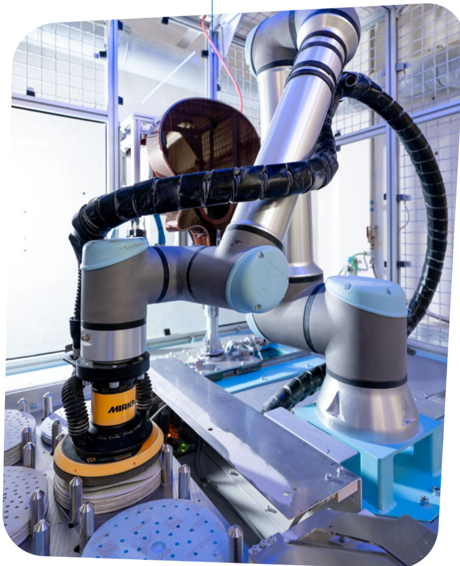
Zásobník brusiva v jednotce automatizované výměny
