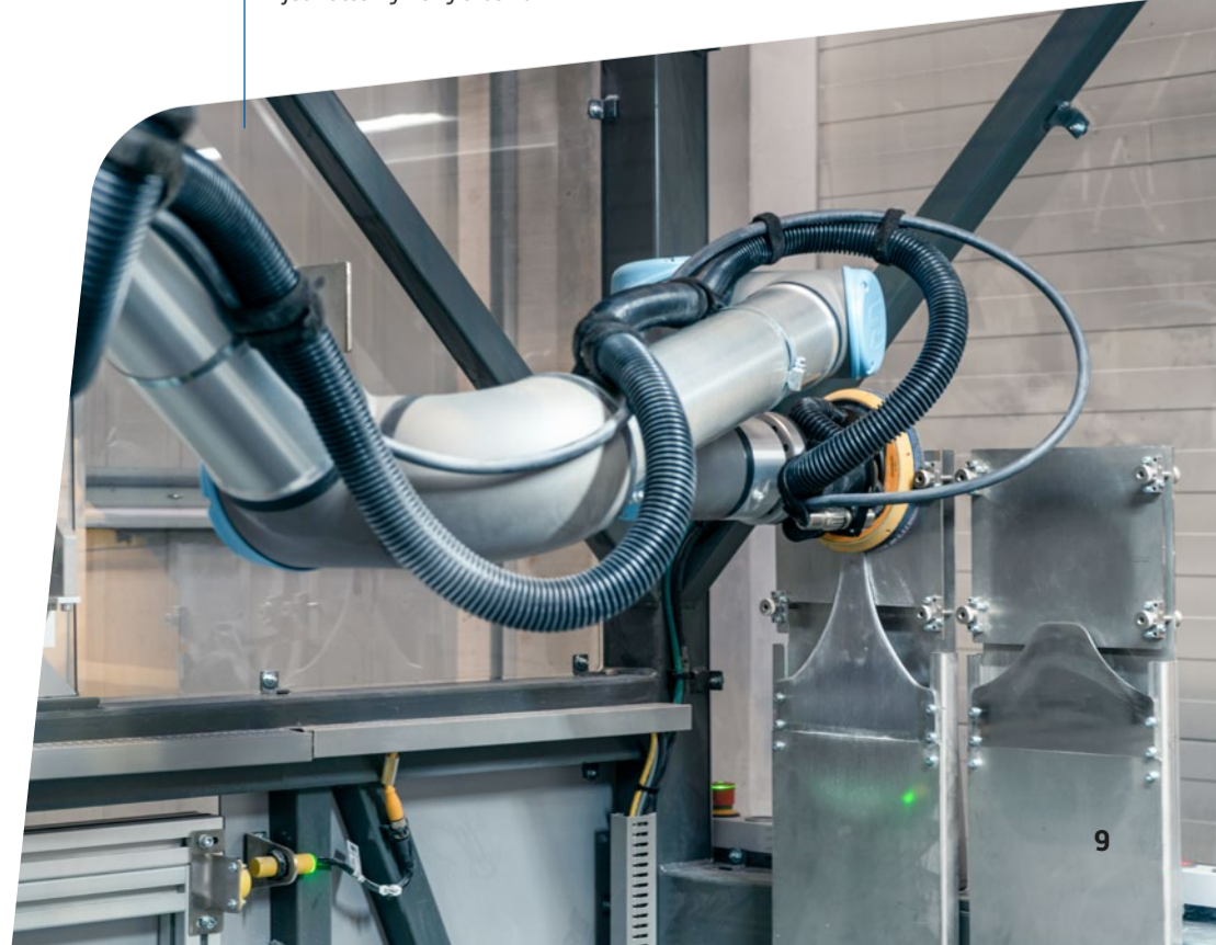
Sejmutí použitého brusiva v automatizované jednotce výměny brusiva
