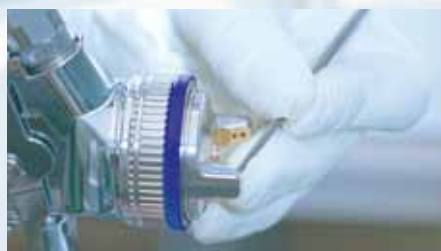
Ruční nastavení: k optimalizaci stříkacího paprsku je každá trysková sada ručně "doladěna".
